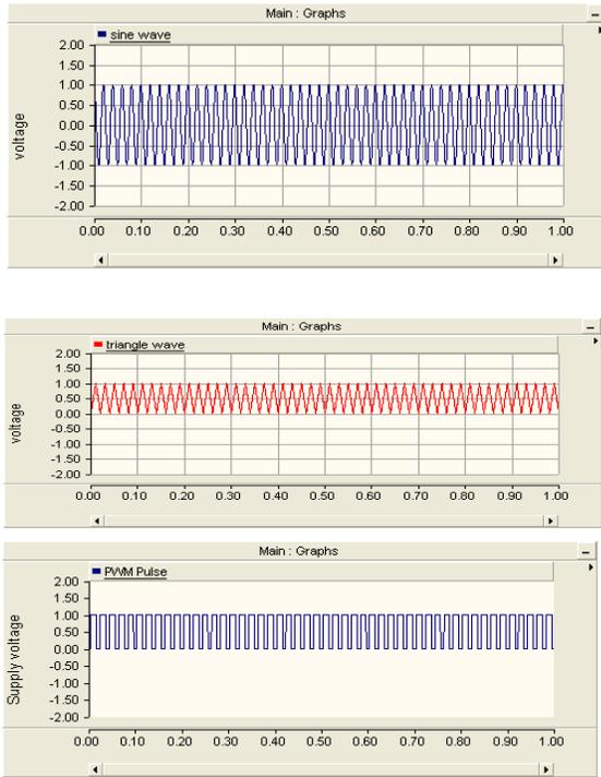
Figure.10. PWM pulse Generation
